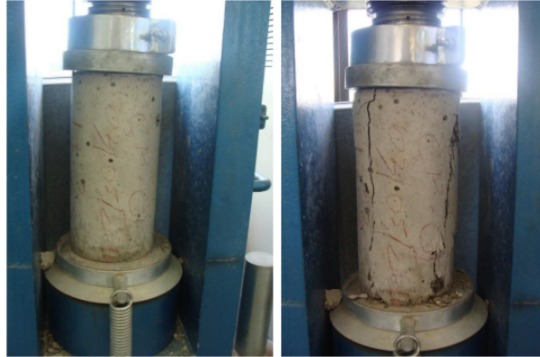
Figura 16: Ensaio de resistência à compressão de concreto com ruptura tipo coluna
